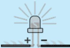
Los **leds** pertenecen a un grupo de componentes electrónicos llamados diodos, que se comportan diferente dependiendo de la dirección en que circula la corriente eléctrica que los atraviesa. Por eso es importante conectarlos bien, ya que se pueden dañar.
