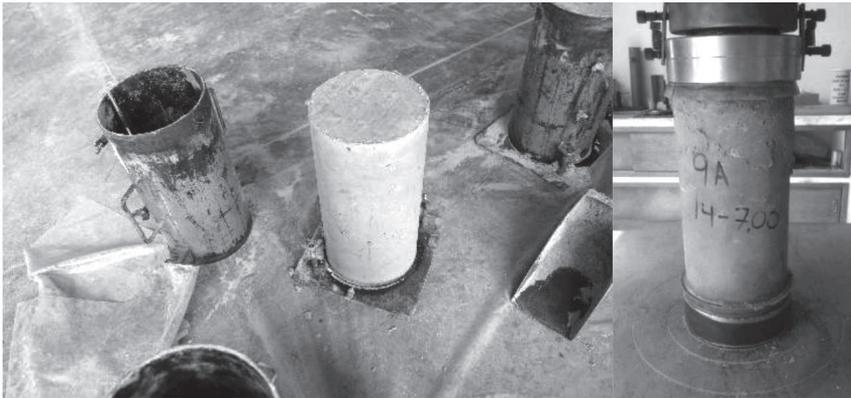
**Figura 3.** Elaboración de especímenes y determinación de la resistencia mecánica
