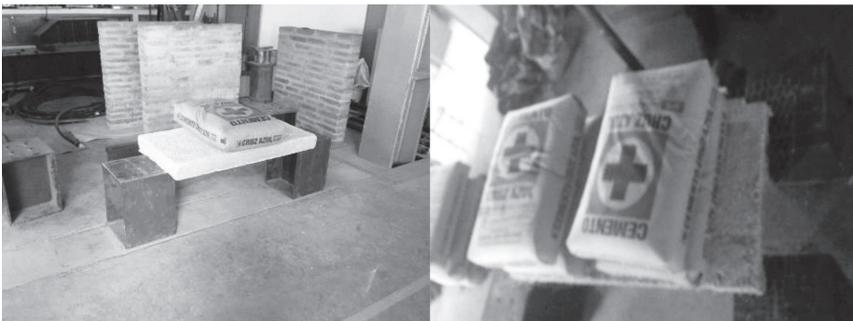
**Figura 5.** Aplicación de cargas cíclicas de carga y descarga en paneles
