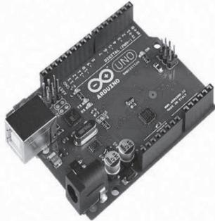
**Figura 1.** Placa de Arduino Uno R3
