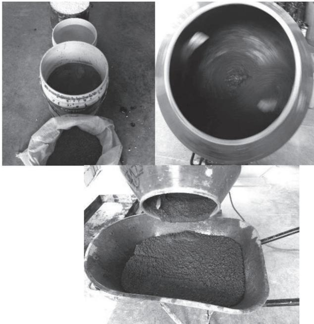
**Figura 2.** Materiales y elaboración de concreto ligero con EPS reciclado como agregado.
