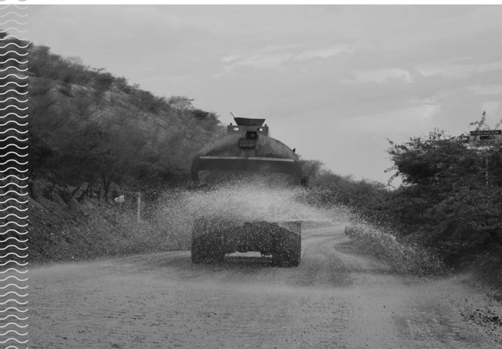
CARRO TANQUE DEL CERREJÓN REGANDO CARRETERAS PARA DISMINUIR POLVILLO DEL CARBÓN.
